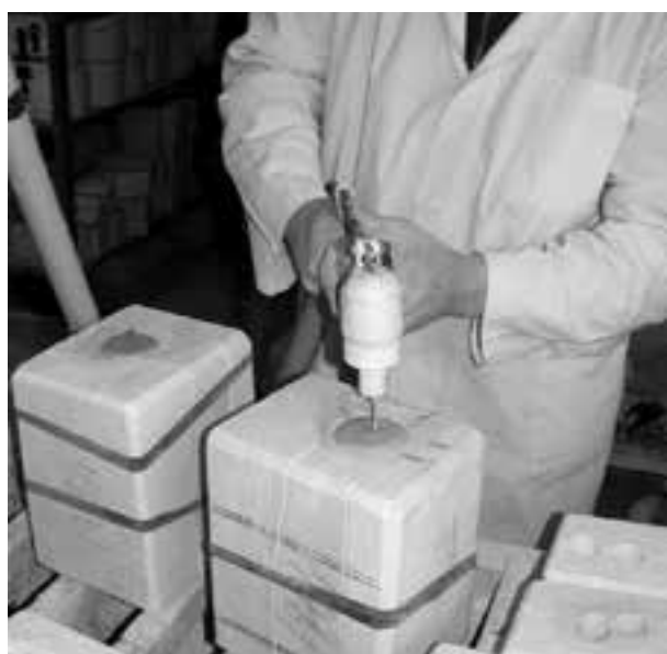
Fase di Colaggio, la Porcellana liquida viene colata negli stampi in gesso.
